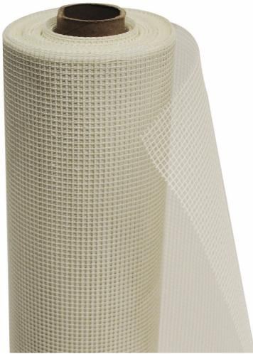
Le Fiber Mesh de Nudura doit être utilisé avec le Parging Mix de Nudura. Ce treillis en fibre de verre résistant aux alcalis est intégré dans la couche de base du crépi pour offrir une résistance supplémentaire. Le treillis en fibre aide également à résister au rétrécissement de la couche de protection une fois le produit complètement durci.
